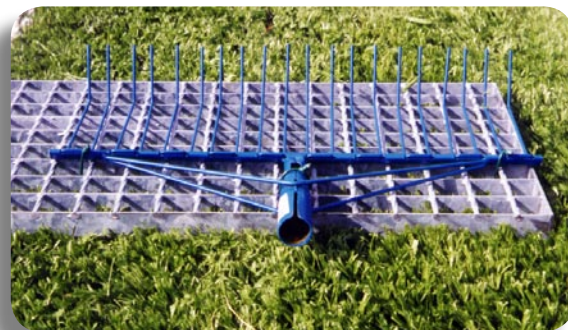
Um rastelo simples ao qual foi adicionado um contrapeso para escarificar a areia e a borracha.
